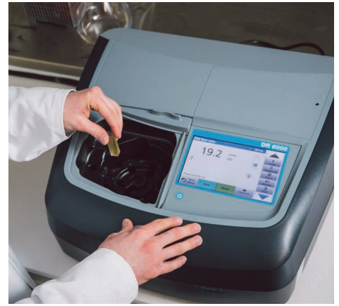
Afbeelding 2. FAN-metingen met een DR6000 UV-VIS-spectrofotometer
