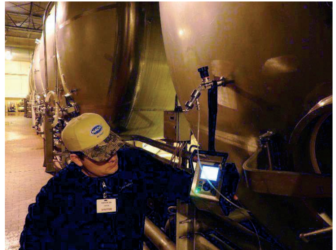
Afb. 4. Draagbare Orbisphere 3100 voor controle
