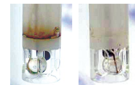
Verontreinigde (links) en schone (rechts) gelelektrolyt
