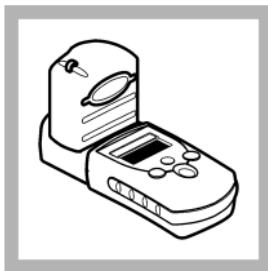
12. Montare il coperchio dello strumento sul vano cella.
