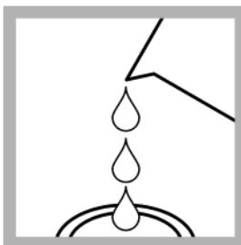
**8.** Bereiten Sie die Probe vor: Füllen Sie eine zweite Küvette mit 10 ml Probe.
