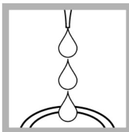
**9.** Fügen Sie das Reagenz der zweiten Küvette hinzu. Warten Sie ggf. die spezifizierte Reaktionszeit zur vollen Farbentwicklung ab.
