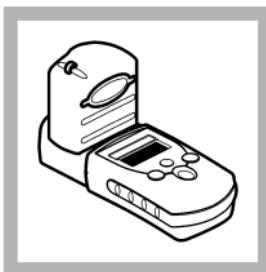
5. Placez le capuchon de l'instrument sur le porte-cuve.
