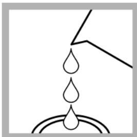
2. **Préparez le blanc :** remplissez la cuve à échantillon avec 10 ml de blanc (généralement, un échantillon).
