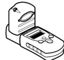
12. Placez le capuchon de l'instrument sur le porte-cuve.
