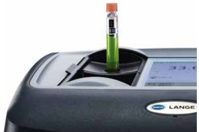
De DR 3900-spectrofotometer kan met de IBR+ barcodelezer tijdens het draaiende meetproces onmiddellijk alle informatie van het kuwet opnemen.
